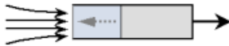
그림 14. 여러 TCP 플로우에 의해 혼잡이 발생하는 경우 - 임의의 TCP 플로우에 속한 패킷을 미리 버림으로써 혼잡이 발생하는 것을 사전에 막을 수 있다.
